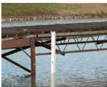
**Piezas de montaje para medidores de nivel de agua**
